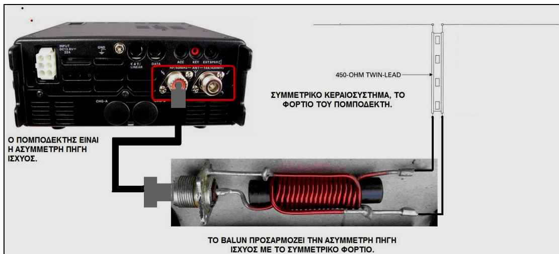
Προσαρμογή ασύμμετρης πηγής, σε συμμετρικό κεραιοσύστημα με Balun.
